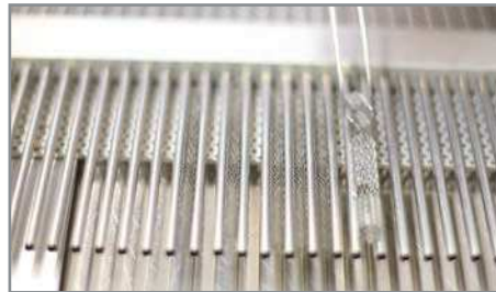
...and layed on the trays for plasma treatment. ... und für die Plasmabehandlung auf den Warenträger gelegt.
